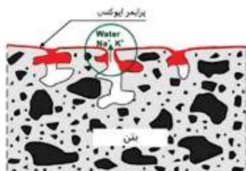
شکل ۶- نمایی از ایجاد نقص داخل آستری روی بتن خشک [۵]
